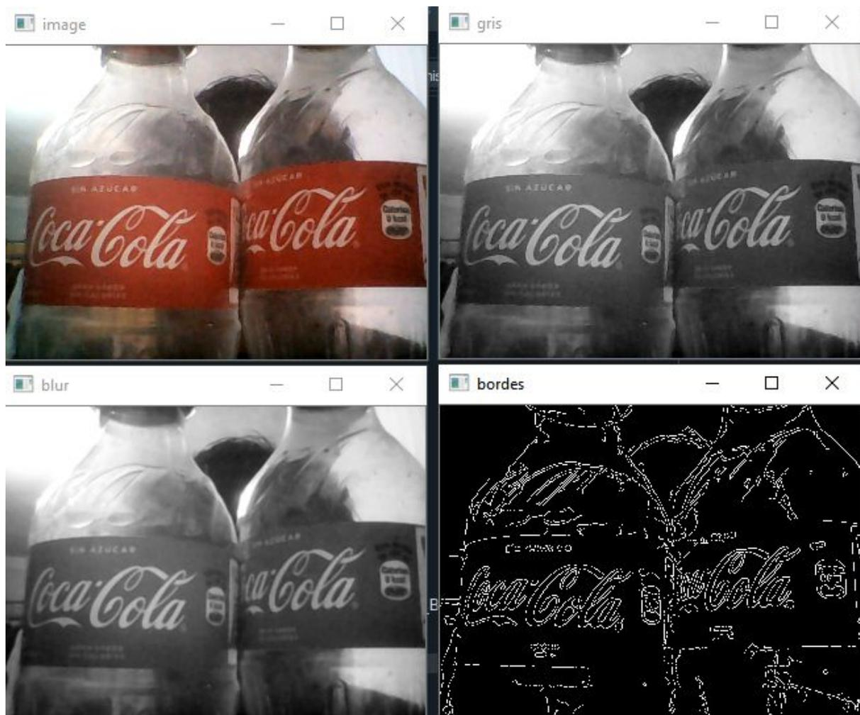
Figura 1, Un ejemplo del proceso de detección de bordes mediante el algoritmo Canny, la imagen original es convertida a escala de grises, la misma que es filtrada con un filtro de desenfoque blur gaussiano y finalmente el algoritmo Canny es aplicado. Fuente, Elaboración propia.
